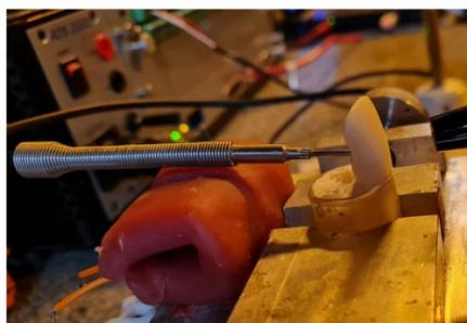
Figura 5 - Termopar tipo J inserido na câmara pulpar na posição da colagem do *bracket*
