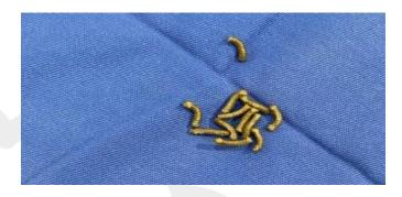
FIGURA 1: Material PET-G com configuração curvada após o processo de esterilização por calor úmido (autoclave). UniRV, 2021.
