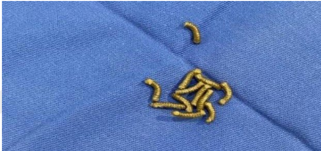
FIGURA 1: Material PET-G com configuração curvada após o processo de esterilização por calor úmido (autoclave). UniRV, 2021.
